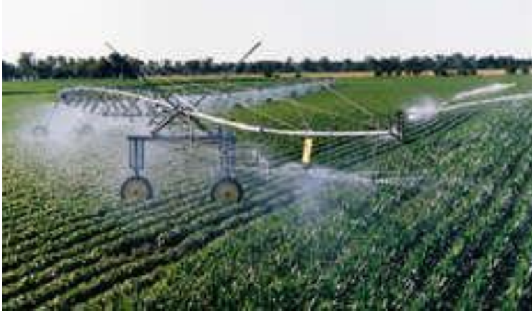
شكل 6-38: نظام ري الأركان بالري المحوري باستخدام برج إضافي صغير.
