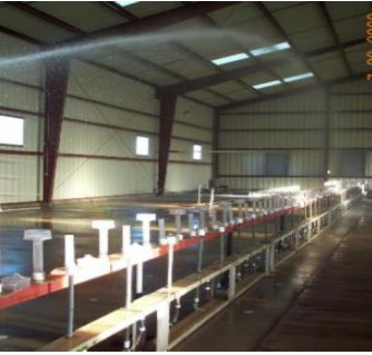
شكل (4-7) اختبار قياس انتظامية توزيع مياه الري تحت الرشاشات حقليا ومعمليا
