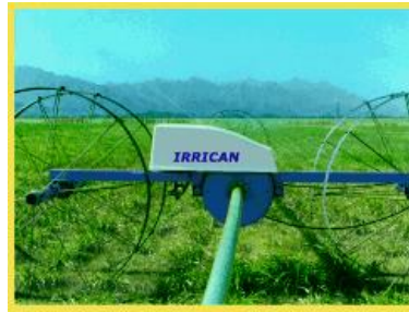
شكل 6-31 : محرك بنزين أو محرك هيدروستاتيكي محمول على شاسيه في منتصف الخط. وبالجانب الأيسر تجهيزة للرشاشات للحفاظ على وضعها رأسيا أثناء دوران الخط.
