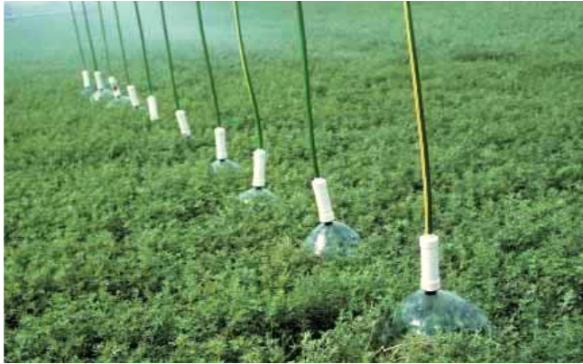
شكل 6-41 : الخط الفرعي مجهز بفوهات رذاذية تعمل بضغط منخفض
