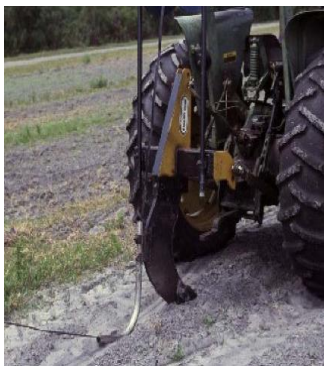
شكل 63-6 : آلة لوضع خطوط التتقيط المدفونة تحت سطح التربة.
